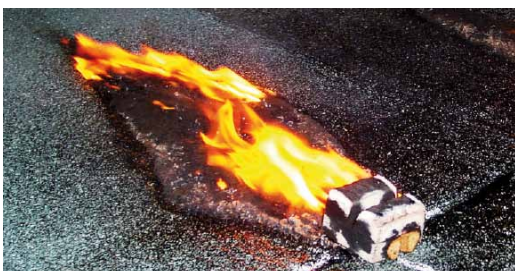
Laboratorní zkouška odolnosti proti ohni
