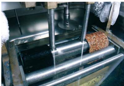
Laboratorní zkouška ohebnosti za nízkých teplot
